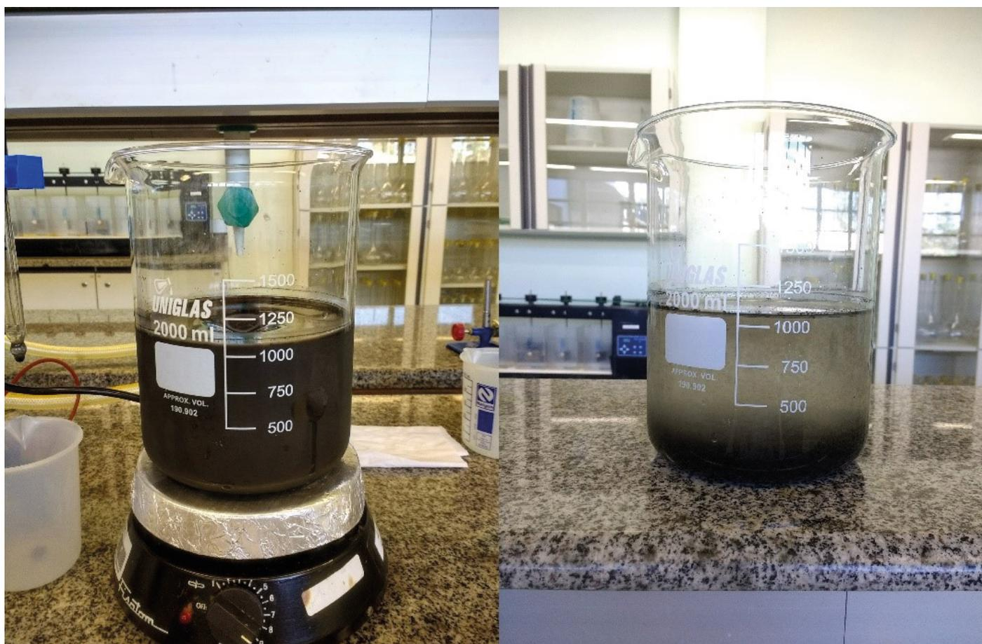
Figura 3 – Efluente bruto após o ensaio de neutralização e floculação.
